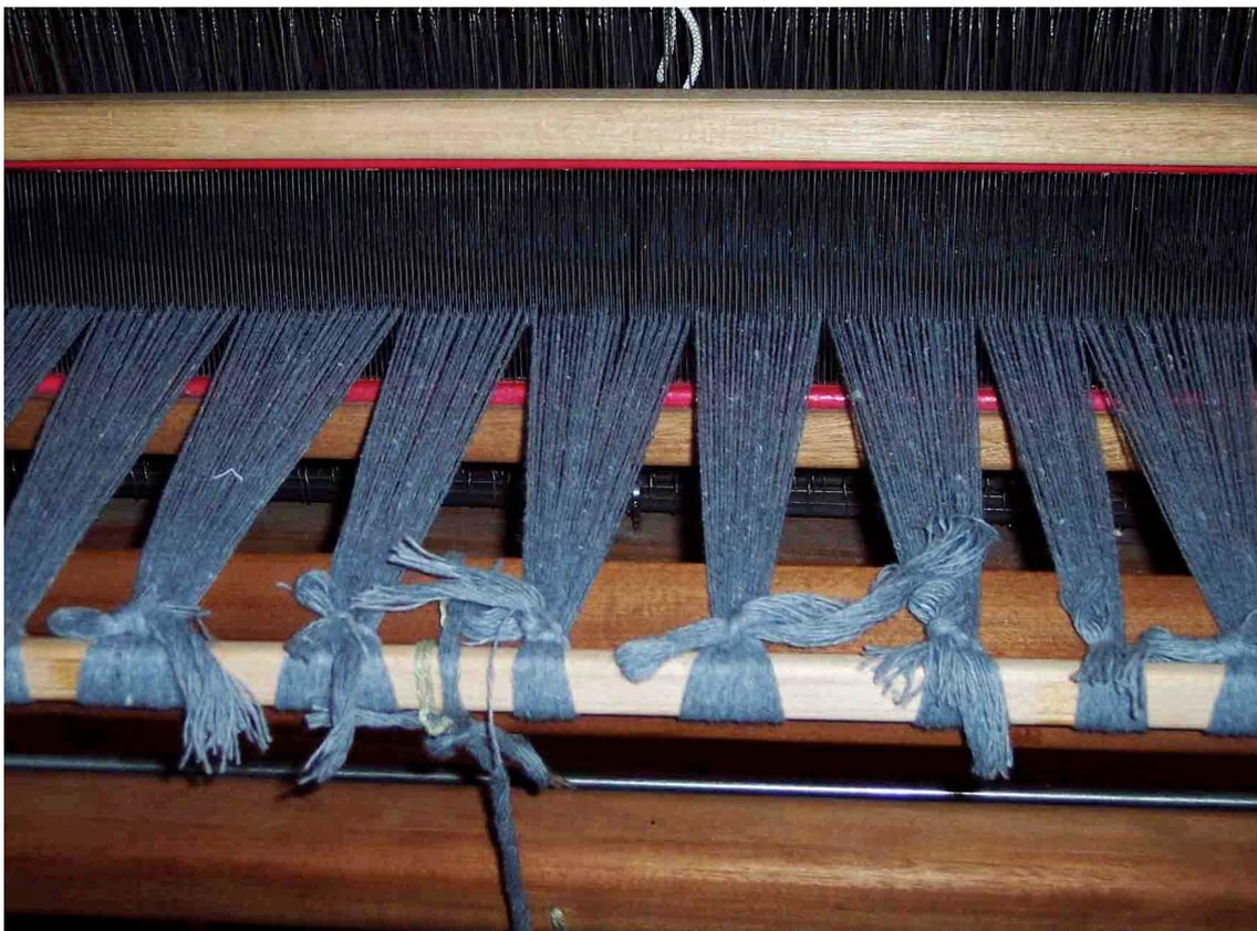
**Figura 30- Picar o pente (preparação para a tecelagem)**
