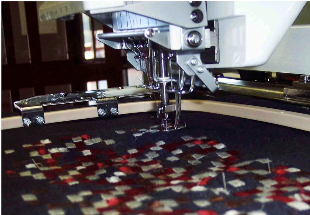
Figura 44- Desenvolvimento do bordado com a máquina
